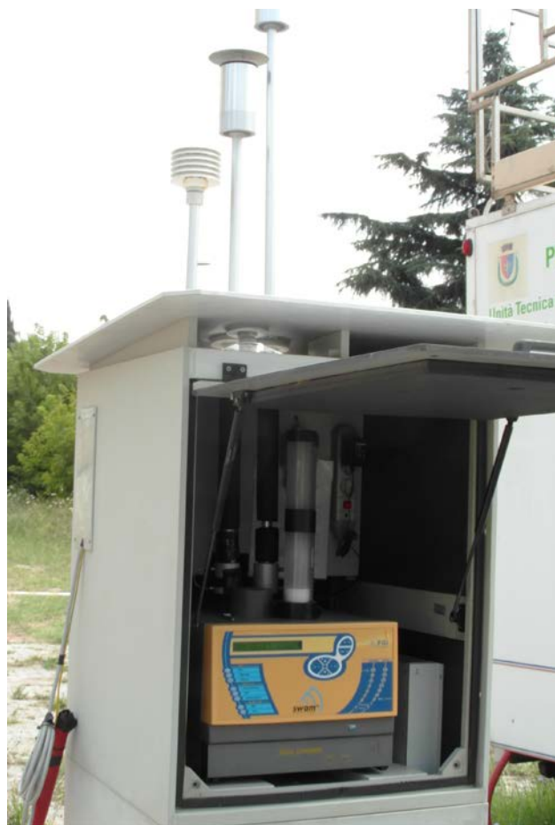
Figura 2: Prelevatore per il PM_{10} e per il PM_{2,5} , operante a una portata di 2,3 \text{ m}^3/\text{ora} , in grado di raccogliere la frazione toracica PM_{10} e respirabile PM_{2,5} , depositandole su due filtri distinti. E' conforme alle specifiche richieste dalla normativa italiana (DLgs 155/2010 s.m.i).
